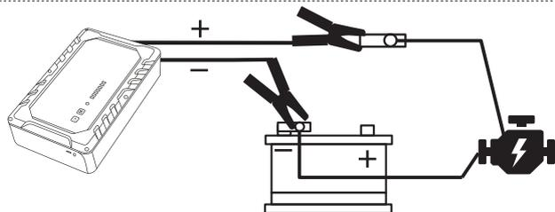
Отсоедините клемму (+) АКБ и подсоедините к ней красный зажим (+) аппарата STARTRONIC. Подсоедините черный зажим (-) к клемме (-) АКБ.
