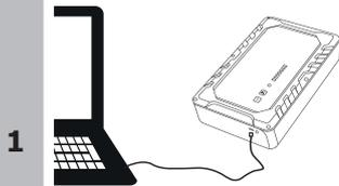
über den Mikro-USB-Port (2). Sie können den Port an Geräten anschließen, die mit einem 5V/2A-USB-Port ausgestattet sind. Das USB-Ladekabel ist nicht im Lieferumfang enthalten. Eine Komplettladung über USB benötigt bis zu 15 Minuten.
