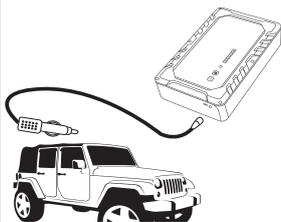
Collegare l'adattatore macchina (8) sulla presa accendisigari di un veicolo. Collegare alla porta di entrata (3) dello STARTRONIC l'altra estremità dell'adattatore per avviare la carica. La ricarica completa del dispositivo durerà circa 2 minuti.
