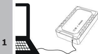
Lo STARTRONIC potrebbe essere ricaricato grazie alla porta micro USB (2) con tutti i dispositivi elettronici con una porta USA 5V 2A. Il cavo di carica USB non è fornito. La ricarica completa del dispositivo durerà circa 15 minuti.
