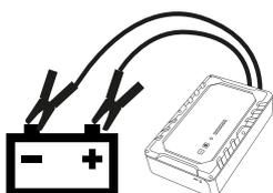
Connectez le STARTRONIC à une batterie 12V de substitution et appuyez sur le bouton Marche/arrêt pour démarrer la charge (La recharge complète de l'appareil prendra environ 2 minutes).
