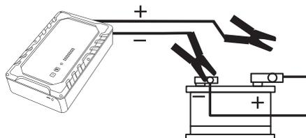
Retire la pinza roja (+) del terminal fijado a la batería.
