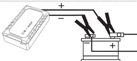
Coloque el conjunto de nuevo: terminal y pinza roja (+) sobre el borne (+) de la batería.
