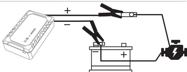
Scollegare il capocorda (+) della batteria e collegare il morsetto rosso (+) dello STARTRONIC su di essa. Collegare il morsetto (-) sul capocorda (-) della batteria.
