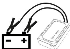
Sluit de STARTRONIC aan op een 12V vervangende accu en druk op de Aan/uit knop om het laden op te starten. Het opladen van het apparaat duurt in totaal ongeveer 2 minuten.
