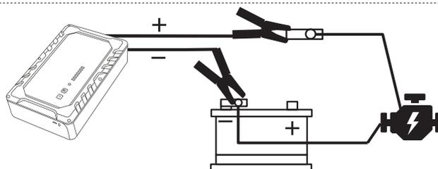
Entfernen Sie den (+)-Anschluß an der Batterie und verbinden Sie die rote Klemme des Startronic mit dem zuvor entfernten Anschlußkabel. Verbinden Sie jetzt schwarze Klemme des Startronic mit dem (-)-Pol der Batterie.
