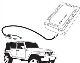
Branchez l'adaptateur voiture (8) sur la prise allume cigare d'un véhicule. Branchez au port d'entrée (3) du STARTRONIC l'autre extrémité de l'adaptateur pour démarrer la charge (La recharge complète de l'appareil prendra environ 2 minutes).
