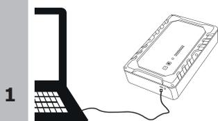
Le STARTRONIC peut être rechargé grâce à son port micro USB (2) avec tous les appareils électroniques équipés d'un port USB 5V 2A. Le câble de charge USB n'est pas fourni (La recharge complète de l'appareil prendra environ 15 minutes).
