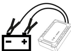
Collegare lo STARTRONIC a una batteria 12V di sostituzione e premere sul tasto On/Off per avviare la carica. La ricarica completa del dispositivo durerà circa 2 minuti.
