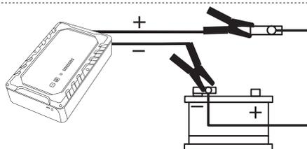
Desconecte el terminal (+) de su batería y conecte la pinza roja (+) del STARTRONIC sobre esta. Conecte la pinza negra (-) sobre el terminal (-) de su batería.
