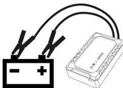
Mit einer 12V-Ersatzbatterie. Drücken Sie auf den Ein/Aus-Taster, um den Ladevorgang zu starten. Eine Komplettladung benötigt bis zu 2 Minuten.
