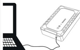
De STARTRONIC kan opgeladen worden dankzij zijn micro USB uitgang (2) met alle elektrische apparaten uitgerust met een USB 5V 2A uitgang. De USB laadkabel wordt niet standaard meegeleverd. De complete laadprocedure van het apparaat duurt ongeveer 15 minuten.
