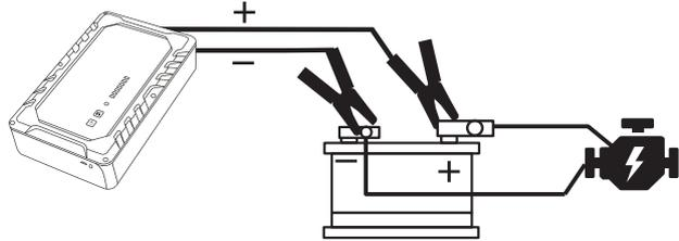
Montieren Sie jetzt den (+)-Anschluß wieder gemeinsam mit der roten Klemme des Startronic am (+)-Pol der Batterie.
