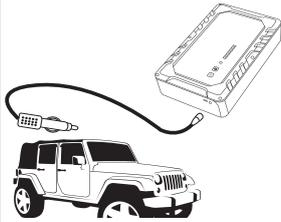
über das Zigarettenanzünderanschlusskabel (8) an einem anderen Fahrzeug. Schließen Sie es über den Eingangsport des Startronic an um den Ladevorgang zu starten. Eine Komplettladung benötigt bis zu 2 Minuten.
