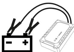
Conecte el STARTRONIC a una batería de 12V de sustitución y presione el botón de encendido/apagado para iniciar la carga. La recarga completa del aparato dura alrededor de 2 minutos.
